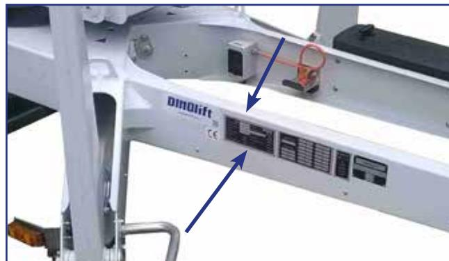
Piekabes tehnisko datu plāksnīte atrodas uz dīseles, pacēlāja tehnisko datu plāksnītes labajā pusē, kā norādīts attēlā.
